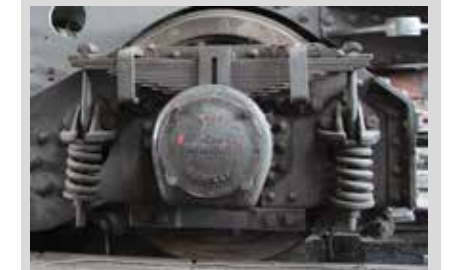
▲ A hátsó forgóváz rugózása (fotó: Tóth Zétény)
