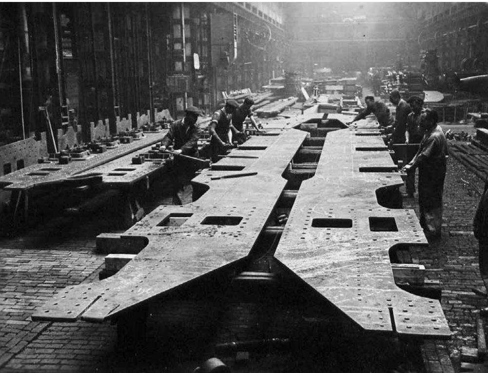
▲ A főkeretlemezsze hossza 15 600, vastagsága 28 milliméter. Ilyen méretű síklemez meleghengertése a mai magyar iparnak komoly kihívást jelentene
