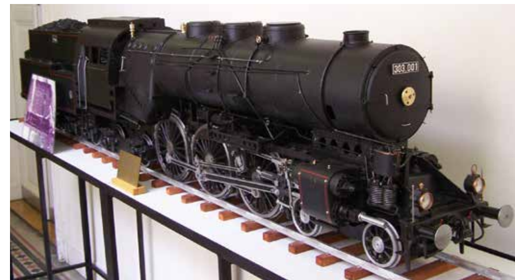
▲ A modell füstterelő nélküli képén jól megfigyelhető a mozdony szerkezete és a füstszekrény alátámasztásának számos könnyítő furata
